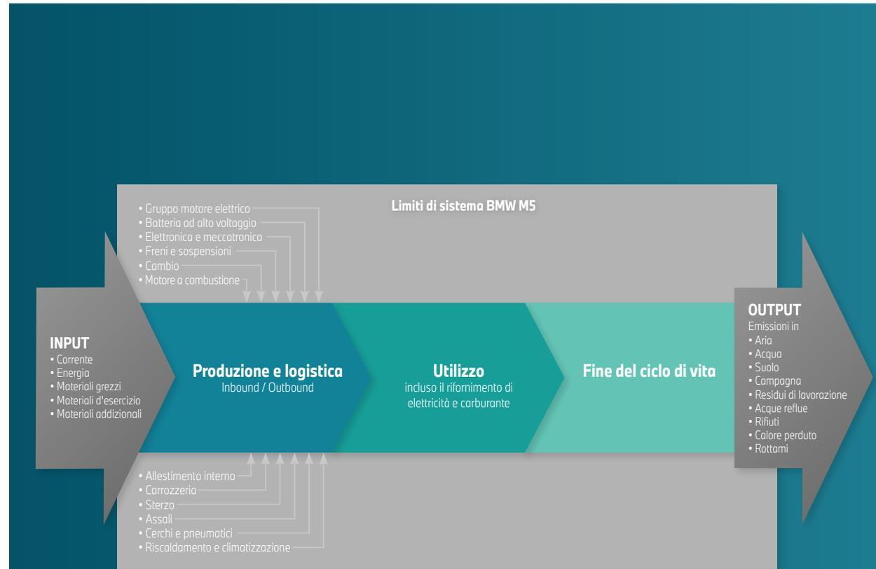
Fig. 1: Limiti di sistema Ecobilancio BMW M5
